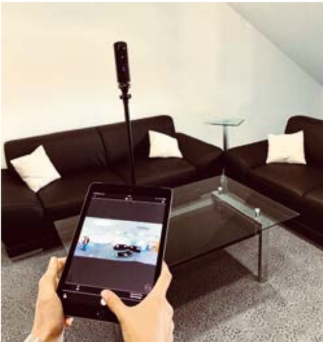
Fernsteuerung per App: Die Kamera wird aus dem Nebenraum mit einem Tablet oder Smartphone bedient, um die Fotos für den Rundgang zu erstellen.
